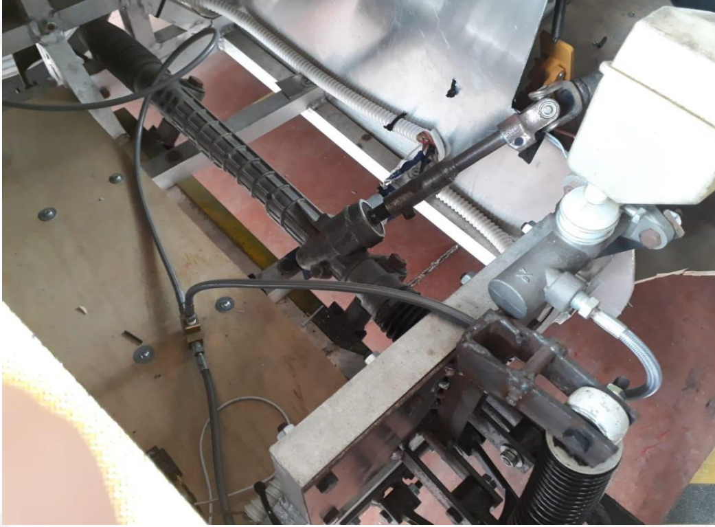
Şekil A. Tek merkezli fren sistemi, sadece ön iki tekerde fren mevcut, fren hortumları sabitlenmemiş, uygun olmayan bir fren tasarımı örneği.
