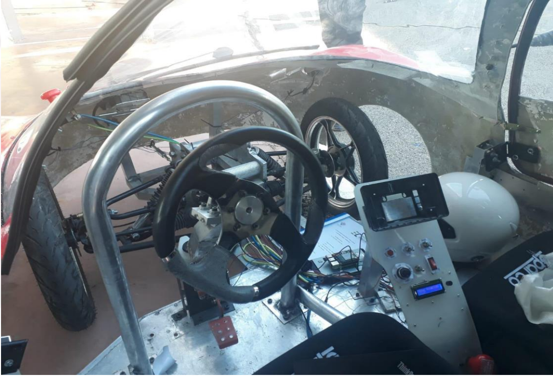
Şekil D. Kokpit ile dış ortam uygun bir şekilde izole edilmemiş, pilotun yarış esnasında dış ortamdan gelecek zararlara karşı yeterli koruması yok, tekerler ile pilot arasında yeterli koruma yok, uygun olmayan kokpit tasarımı örneği.
