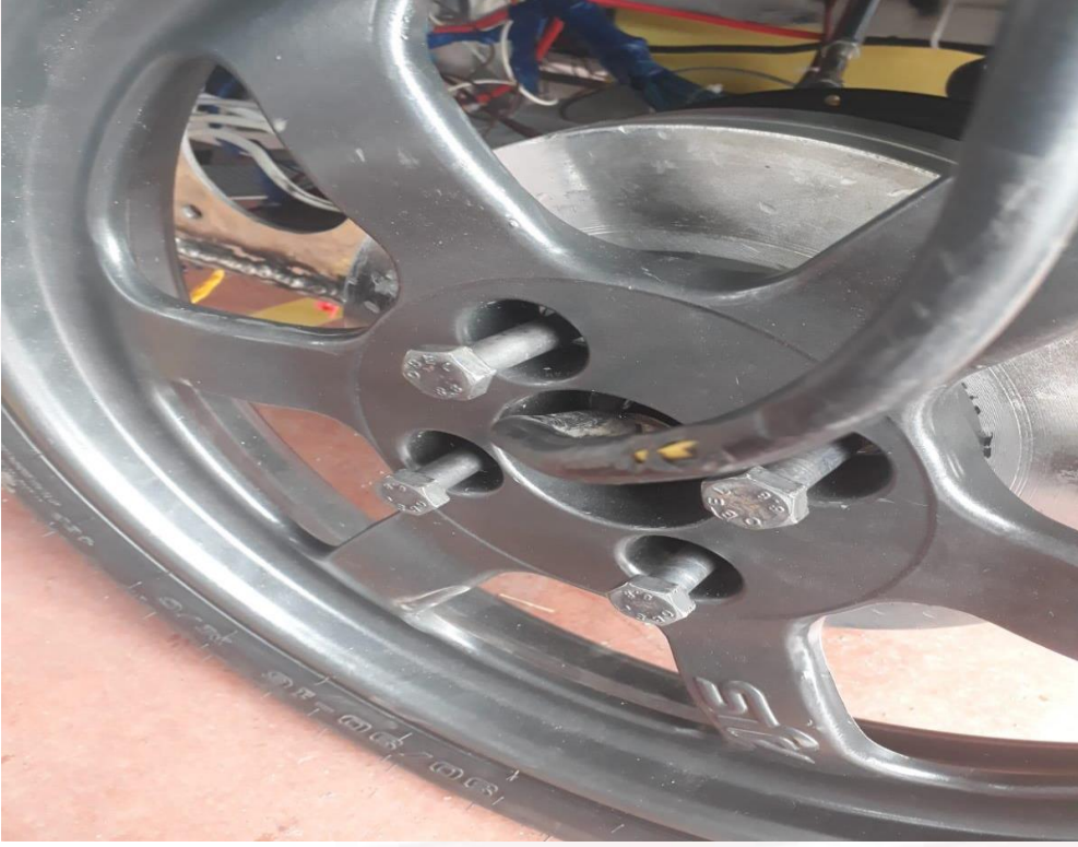
Şekil E. Jant dışında taşan civata başları, civatalar tarafından koparılması muhtemel kablo, uygun olmayan teker tasarımı örneği.
