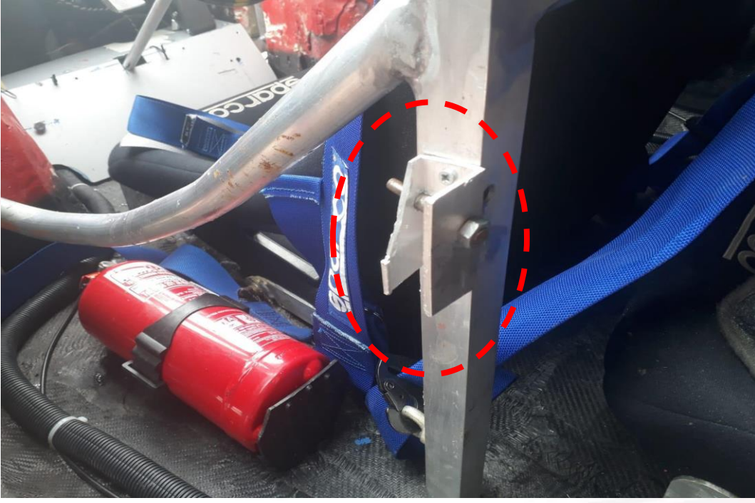
Şekil C. Kokpit içerisinde sürücü güvenliğini riske atacak keskin köşeli plaka mevcut, kokpit içerisinde civata ucu mevcut, uygun olmayan kokpit tasarımı örneği.
