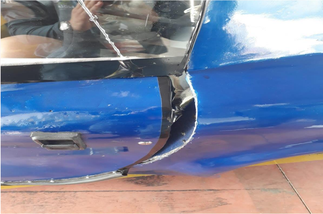
Şekil B. Kapı ile gövde arasında boşluk mevcut, uygun olmayan kapı tasarımı örneği.
