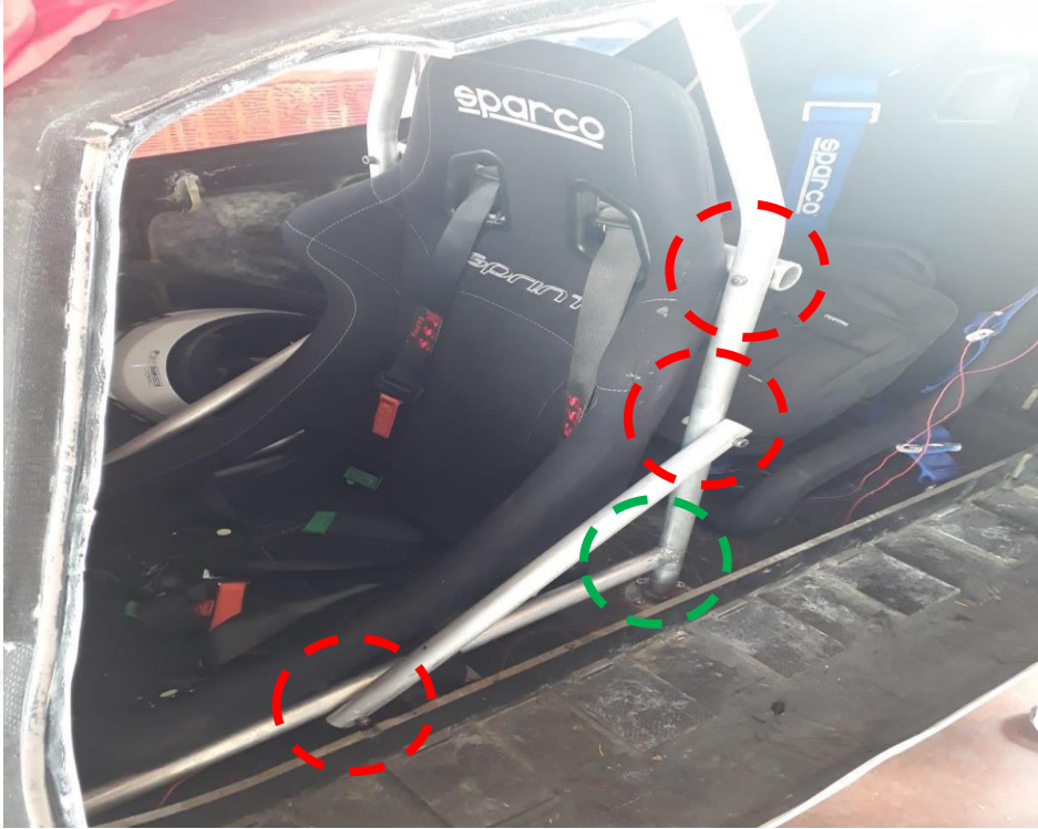
Şekil F. Roll bar elemanları civata ile birleştirilmiş, büküm yapılmayan noktalarda kaynaklı birleştirme olmalı, sadece şasi ve roll cage bağlantısında civatalı birleştirme kullanılabilir, uygun olmayan roll bar tasarımı örneği.
